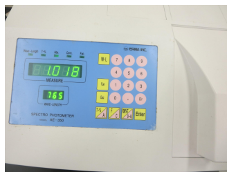
分光光度計で吸光度を測定している様子
